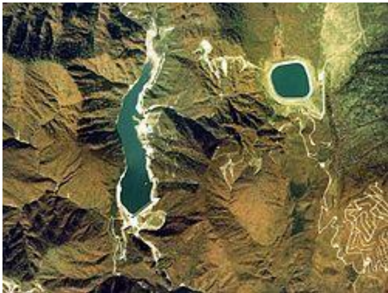
上池として皿状の人造湖を設けた純 揚水発電所の例（国土交通省、国土画像情報 （カラー空中写真）より作成した電源開発沼原発電所 （1976年11月18日および22日撮影））
